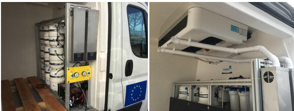
Bevochtigingsapparatuur in de Fresh-Demo bus
